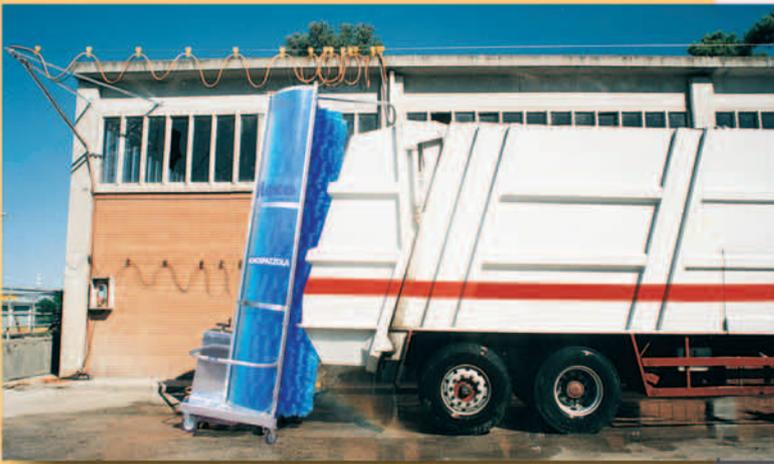
Utilizzabile sia all'aperto che in ambienti chiusi, L50 non necessita di una collocazione fissa. Grazie alle dimensioni massime di 2 mq, dopo l'utilizzo, è facilmente collocabile ovunque. L'allacciamento dei cavi di alimentazione può essere effettuato con sistema aereo, molto pratico e ordinato, oppure lasciando i cavi liberi al suolo.
