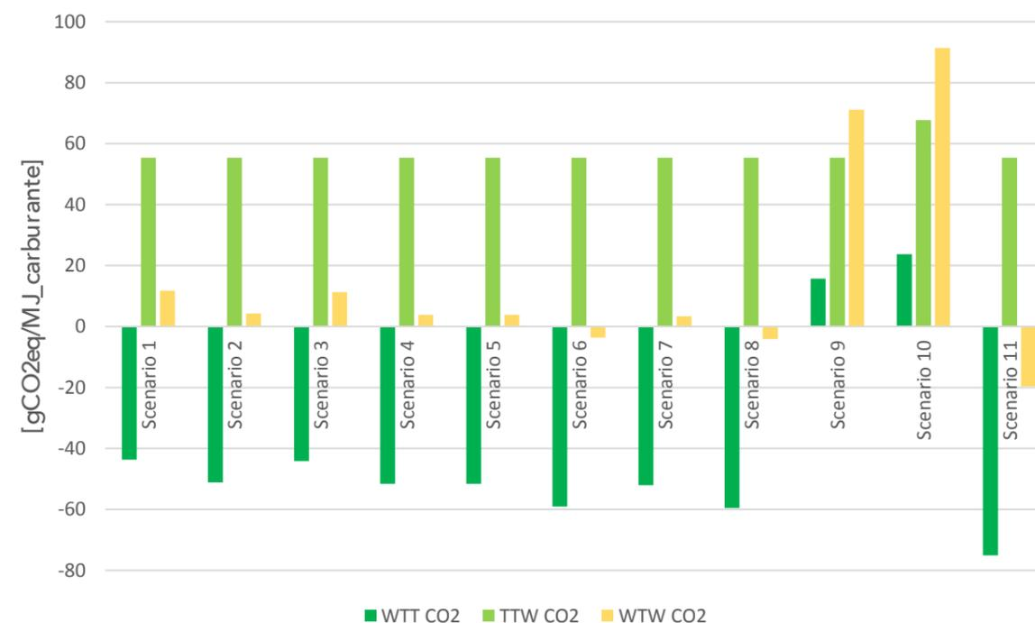
Figura 1: Comparazione dei risultati delle analisi WTW per tutti gli scenari, per emissioni di CO<sub>2</sub>eq
