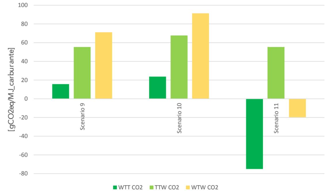
Figura 3: Dettaglio della comparazione delle emissioni climalteranti per gli scenari 9, 10 e 11, normalizzata sui MJ espressi dal carburante
