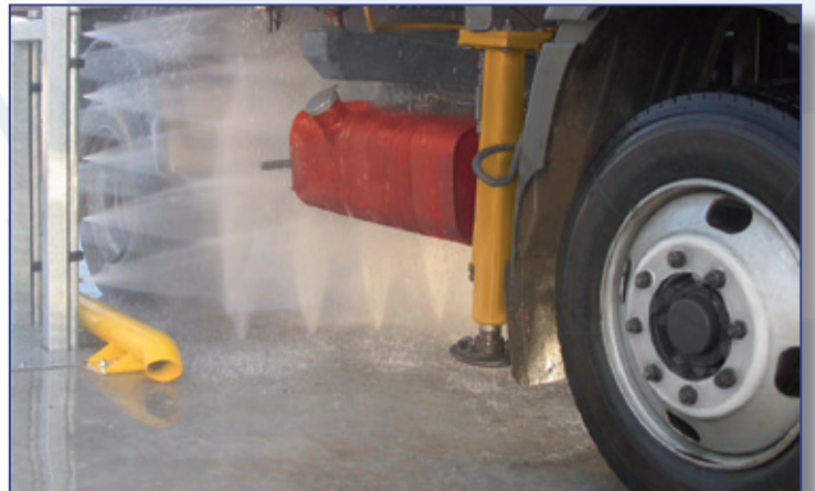
Sistema di lavaggio a passaggio, una serie di ugelli opportunamente posizionati permettono una pulizia in profondità del chassis
