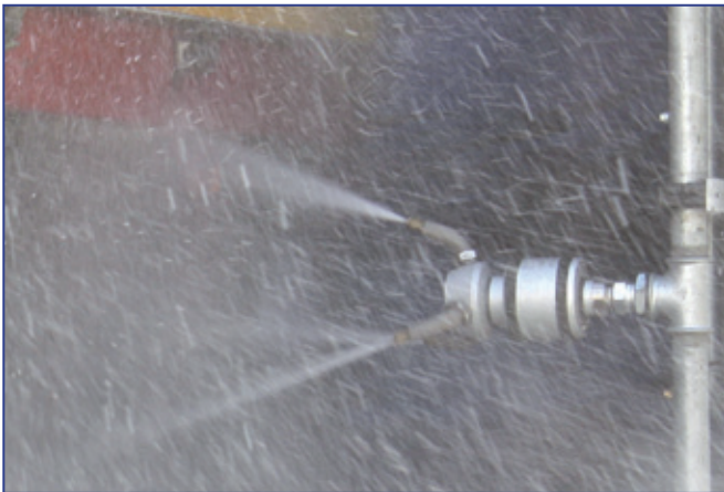
Testa rotante ad alta pressione da 20 a 80 bar per un lavaggio energetico e profondo del telaio
